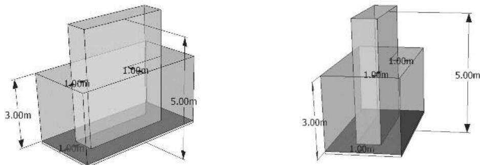
**HALL 1 : La présence de gaines de ventilation à l'intérieur le long des parois, limite la hauteur des aménagements à 3 m sur une profondeur de 1,5 m à partir du bardage.**
